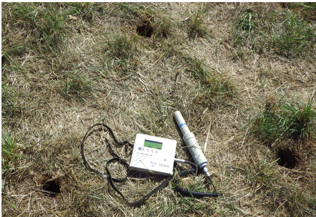
Photo 1 : Mesure radiamétrique au niveau du prélèvement de carottage de sol en trois points
